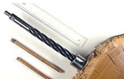
Dendrologický dutý vrták pro pořizování vzorků dřeva a odebrané vzorky
